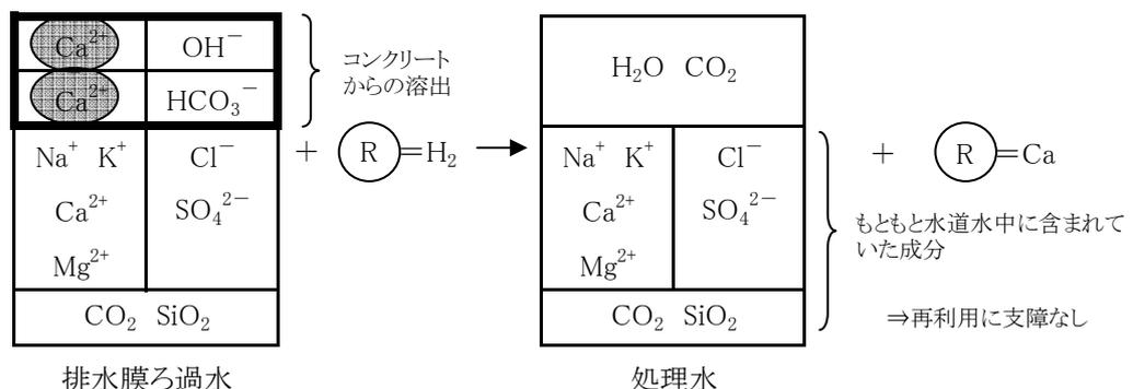
④ 各イオン除去方法の比較(参考として、逆浸透膜(RO)法も併記。)
